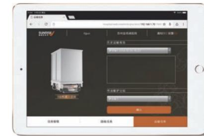
运输功能介绍：系统实时侦测各个站点待发货状态，并自动生成运输任务，选择合适的机器人完成运输。运达目标点后，及时通知收件单位，缩短待货时间
