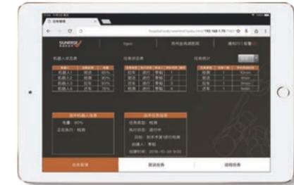
任务管理功能介绍：机器人状态信息(包含当前的任务，电量，和选中机器人的详细信息)、任务状态信息(任务类型、执行状态、发送人、执行顺序及选中任务详细信息)
